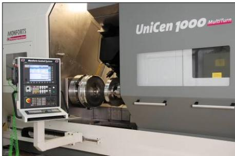
Erfüllt die Forderung vieler Fertiger nach der Komplettbearbeitung von Teilen in einer Maschine: die ‚UniCen 1000‘ von A. Monforts Werkzeugmaschinen, die sich dank einer besonders steifen hydrostatischen Führung besonders für die Hartbearbeitung eignet.
