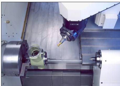
Fast grenzenlose Freiheit bei der Bearbeitung: Auf Maschinen der UniCen-Baureihe von A. Monforts Werkzeugmaschinen können Teile in einer Maschine mit bis zu 120 Werkzeugen gedreht, gefräst und gebohrt werden, ein optionaler Laser sorgt zudem für das Oberflächenhärten, -legieren und -beschichten.
