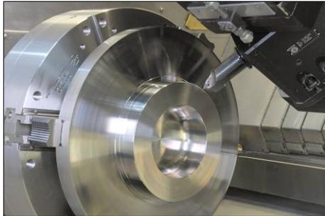
Das Bearbeiten von Turbinenkomponenten wie integral beschaukelten Verdichterstufen, sogenannten BLISKen, ist eine Domäne der von A. Monforts Werkzeugmaschinen auf der EMO vorgestellten ‚UniCen 1000‘.
