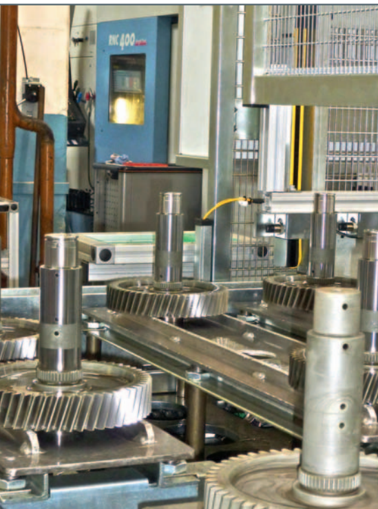
2 Fertigung von Getriebewellen mit der Monforts RNC 400: Das Hartfeindreihen ist bei den Lagersitzen anspruchsvoll, denn der Wälzkörper läuft direkt auf der Welle
