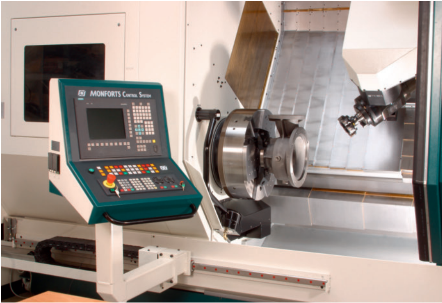
4 Durch die Zusammenlegung verschiedener Arbeitsgänge auf der Unicen 1000 konnte bei der Gehäusebearbeitung eine deutliche Produktivitätssteigerung erreicht werden
