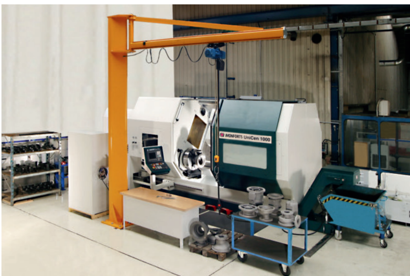
3 Das Dreh-Fräs-Zentrum Unicen 1000 von Monforts wird bei GEA Renzmann & Grünewald für die Komplettbearbeitung von Pumpengehäusen eingesetzt
