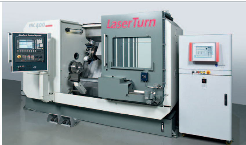
2 Dreh- und Laserwerkzeug sind in der RNC 400 Laserturn von Monforts intelligent und praxistauglich miteinander verknüpft
