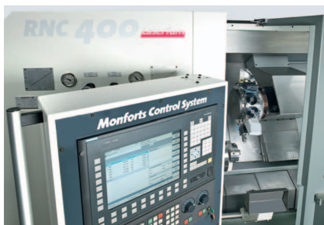
3 Das revolverintegrierte Laserwerkzeug bei der RNC 400 Laserturn ist auf einem Standard-Werkzeugplatz positioniert
