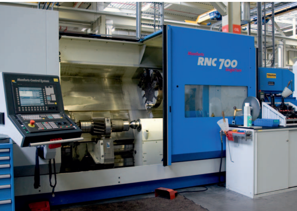
1 Spezialist für die Hartbearbeitung: Beim Hartdrehen der Lagersitze von Sonnen- und Ritzelwellen vertraut Hansen Transmissions auf die Drehmaschinen der Baureihe RNC von Monforts
