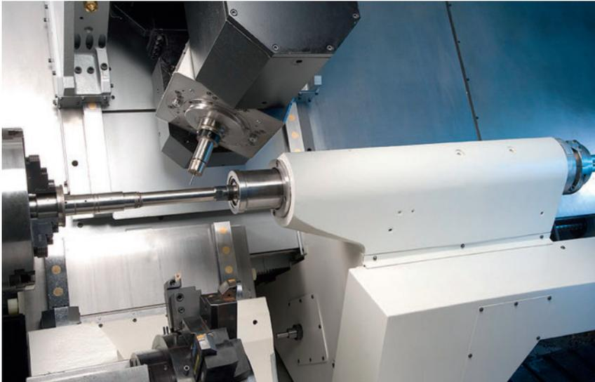
4 Arbeitsraum der Monforts UniCen 504: Die Motorfrässpindel erlaubt präzises Anfahren in beliebigen Positionen
