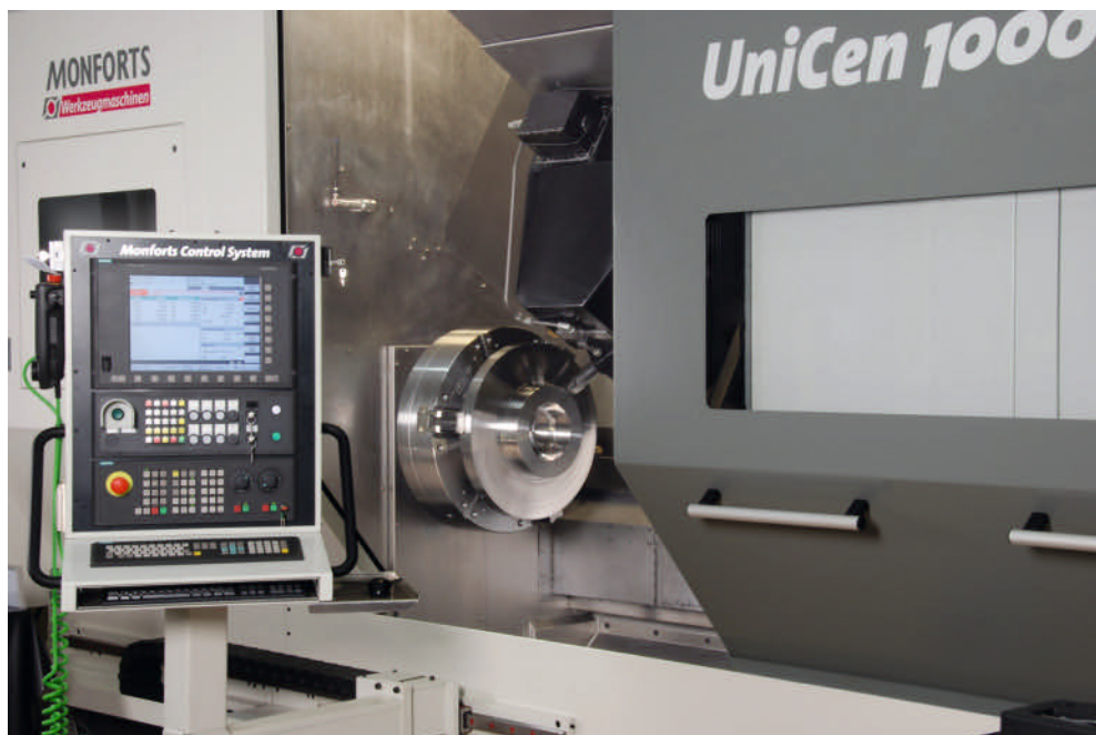
1 Hohe Steifigkeit, ausgeprägte Dämpfung und Dauergenauigkeit: In der UniCen 1000 werden bei der MTU Aero Engines Rotorkomponenten gefertigt
