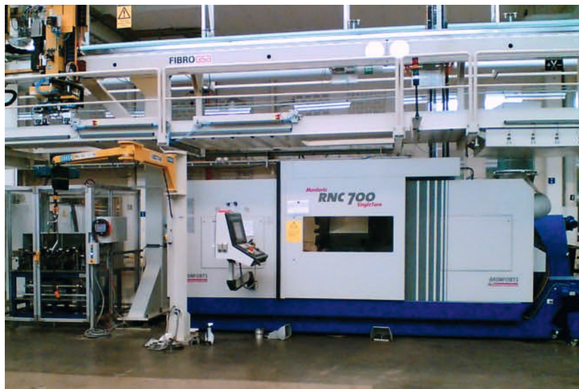
2 Automatisierte Hartbearbeitung mit RNC 700 und Werkstück-Messtation
